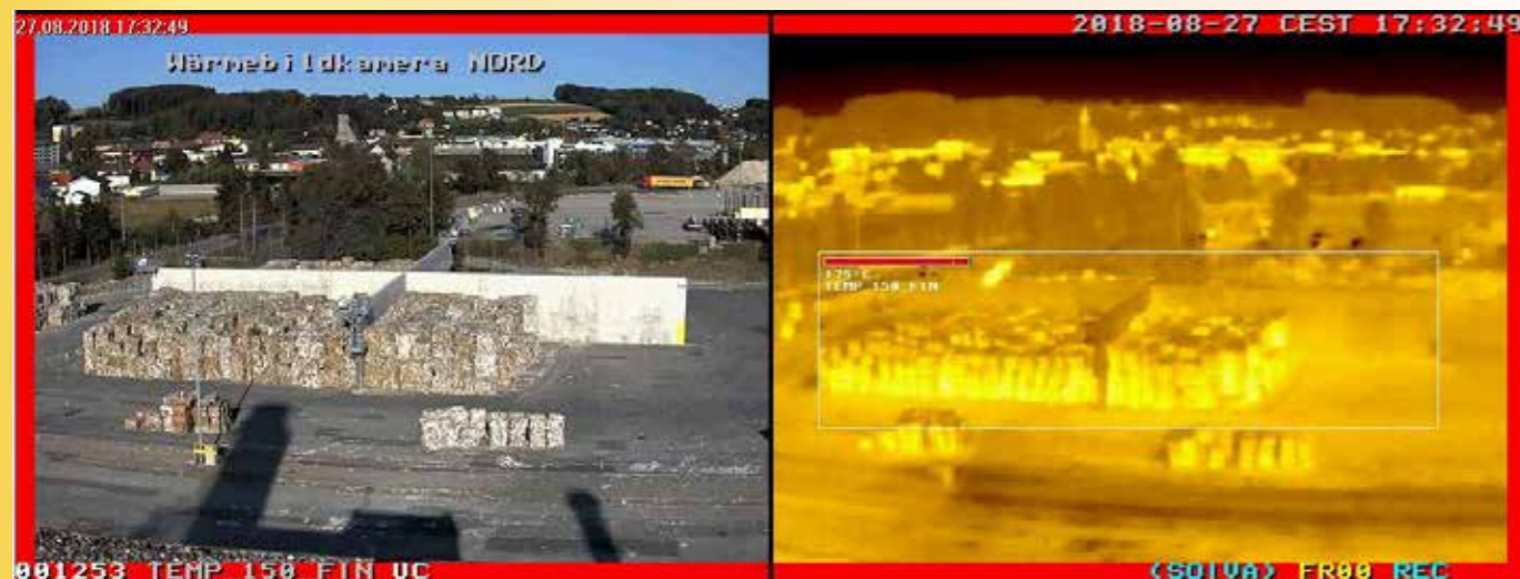
Abbildung 1: Realbild (links) zum Zeitpunkt der Alarmauslösung versus Wärmebild (rechts), in dem bereits die erhöhte Temperatur in der Box links hinten in Folge des Brandes deutlich zu erkennen ist
